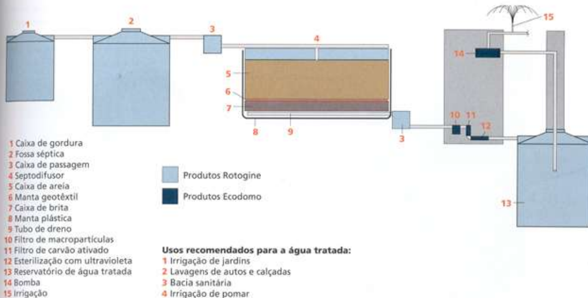
Etadom – Estação domiciliar de tratamento de águas servidas com reuso
